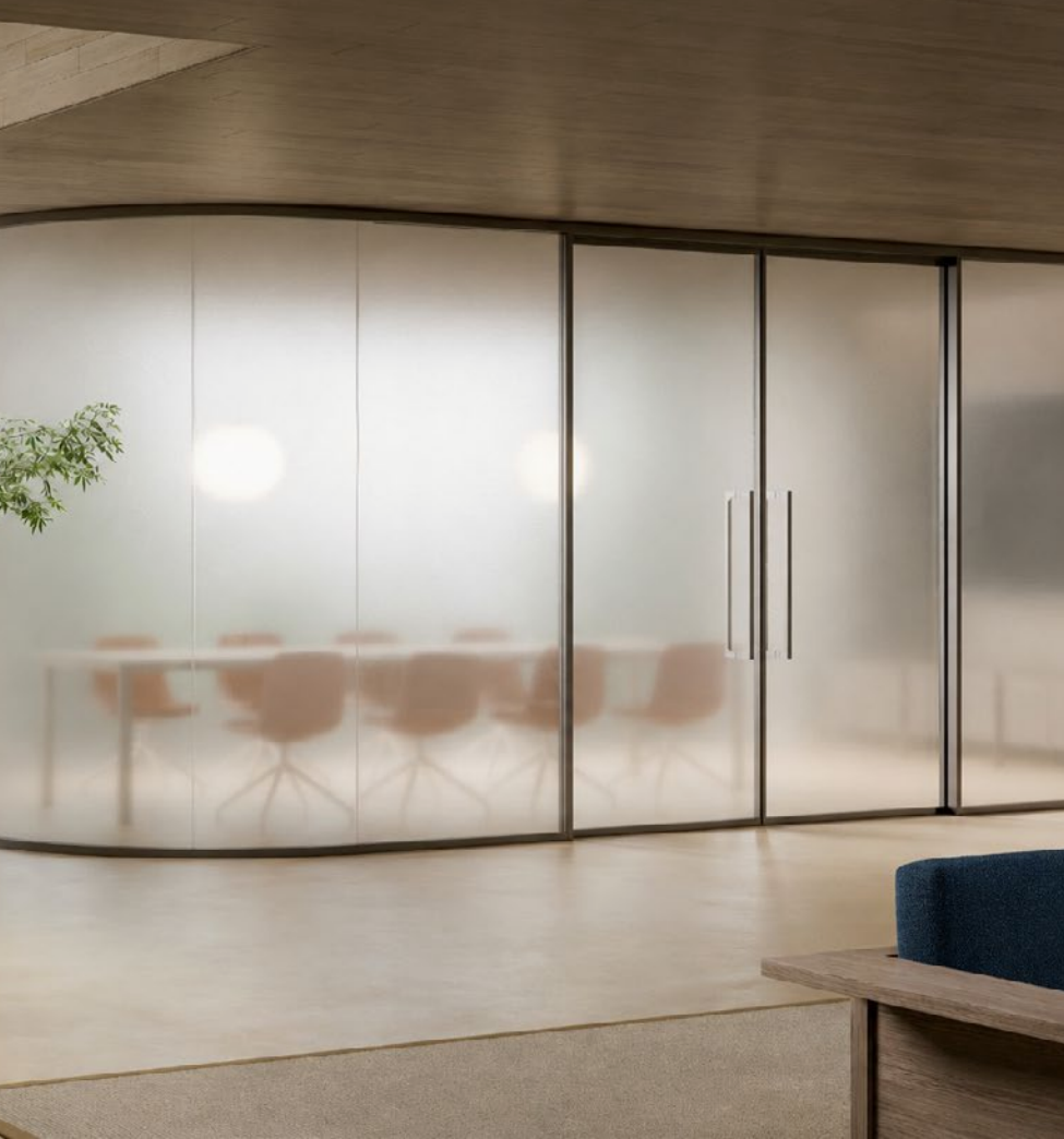
Esempio di vetro acidato installato nella parete vetrata Slender/Example of acid-etched glass installed within the Slender glazed partition system
